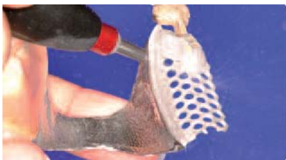
Piąskowanie Al_2O_3 100 \mu m ciśnieniem 2-4 bar
